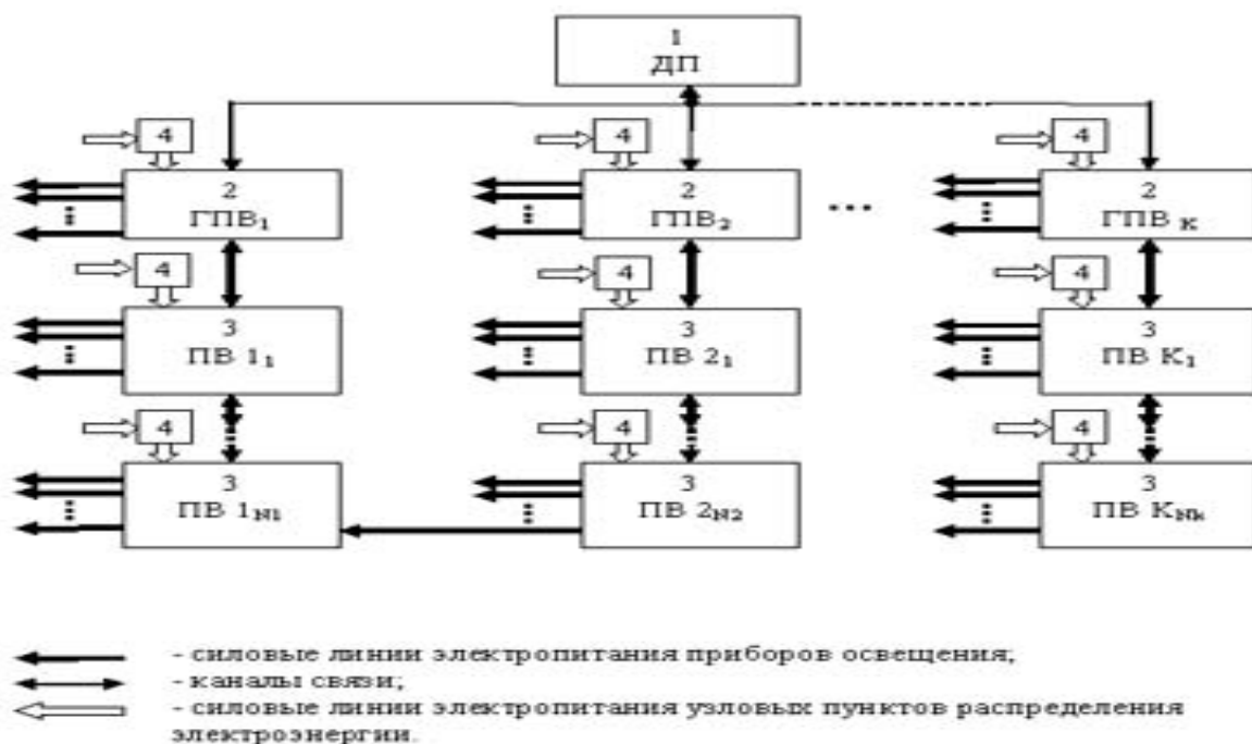
Рис. 4 – Обобщенная схема системы каскадного управления
